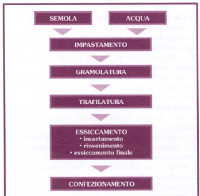
Schema di lavorazione della pasta secca
