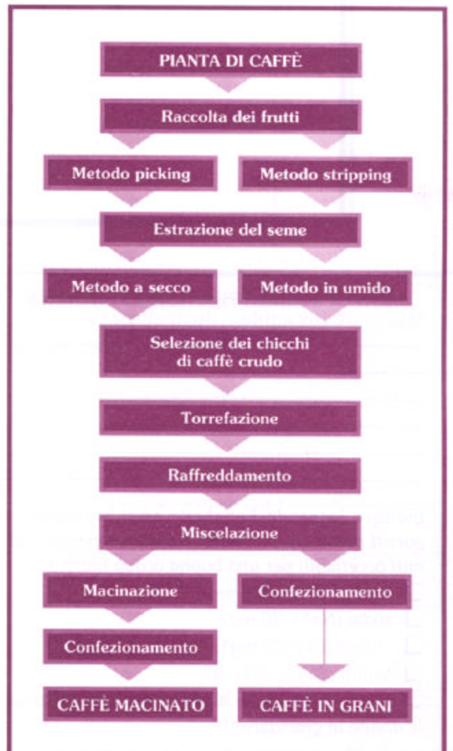
Le fasi principali della lavorazione del caffè
